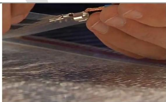
Spojite silikonski licnasti vodič na spojnicu.
